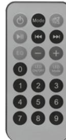
\* Za popolni izklop uporabljajte stikalo na zadnji strani naprave (OFF). Z daljinskim upravljalcem se naprava ne izključi popolnoma, ostane v pripravljenosti, v primeru da je stikalo v položaju ON.
