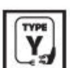
Ukoliko se ošteti priključni kabel, zamenu može da izvrši samo ovlašćeno lice uvoznika ili slična kvalifikovana osoba!
