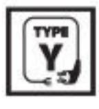
Ak sa poškodí pripojovací kábel, výmenu zverte výlučne výrobcovi, splnomocnenej osobe výrobcu, alebo inému odborníkovi!
