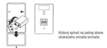
Spínač senzora pohybu v puzdre pre batériu
